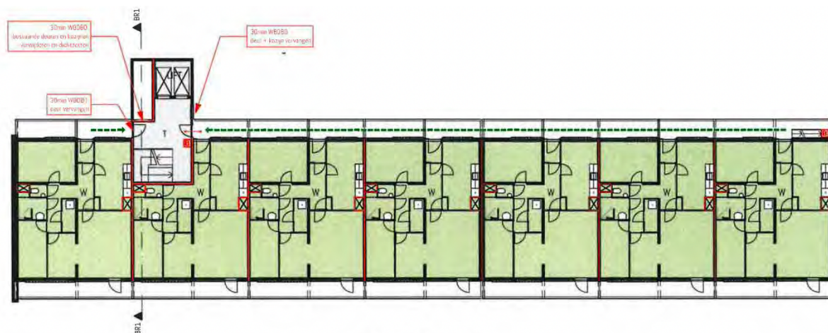
Figuur 1 Principeplattegrond van een verdieping waarop een lange galerij aan het einde toegang biedt tot de stalen noodtrap en aan de andere kant tot het hoofdtrappenhuis.
