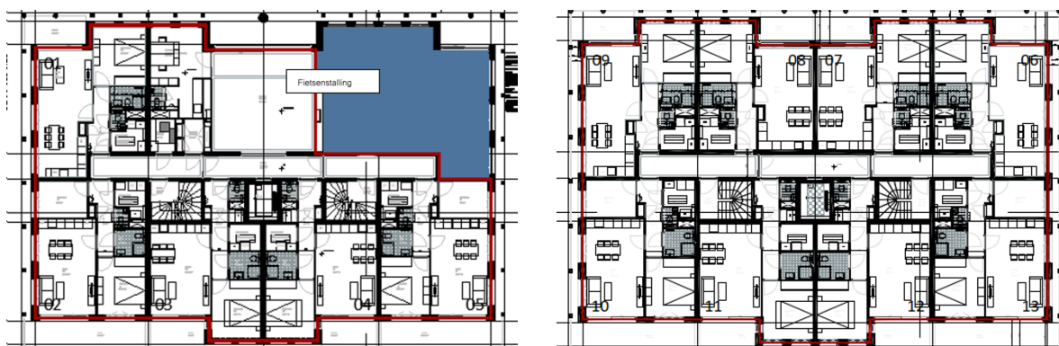
Figuur 2 Begane grond en eerste verdieping situatie 2 waarin de gemeenschappelijke verkeersruimten binnen de thermische schil zijn gelegen. (aangegeven met rode lijn). De ongeïsoleerde fietsenstalling is aangegeven met een blauw vlak.
